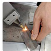
Угловая сварка и вертикальная сварка
