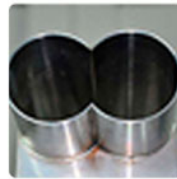
Сварка детали газового уплотнения
