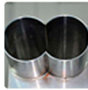
Сварка детали газового уплотнения
