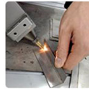
Угловая сварка и вертикальная сварка
